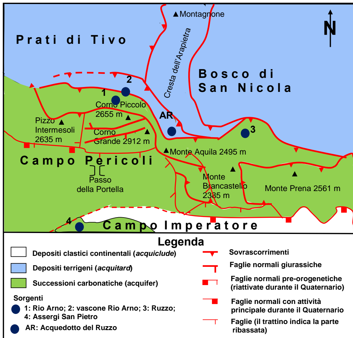
Fig. 5 - Schema idrogeologico dell'area di vetta del Gran Sasso d'Italia, sorgenti principali e unità litologiche.
